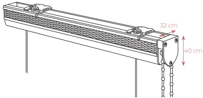
dimensions du système + support (plafond et mur.)
